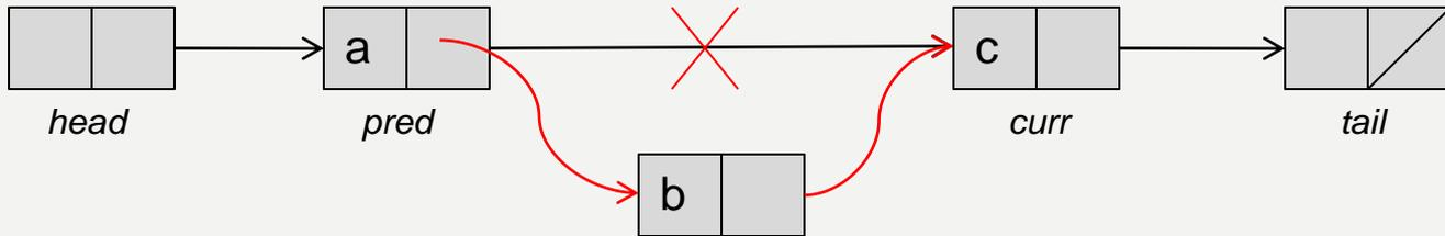
Entfernen von Knoten: remove(b)
