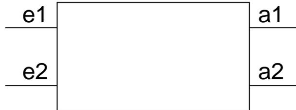
Kommt ein Signal auf einer Eingangsleitung, wird es auf eine Ausgangsleitung weitergeleitet, wobei abwechselnd die obere und die untere Ausgangsleitung verwendet wird (Balancer-Zustand „up“ und „down“).
