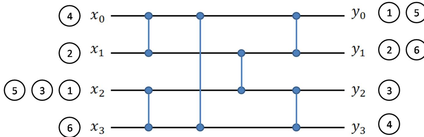
Vertikal: Balancer mit zwei Inputs und zwei Outputs
